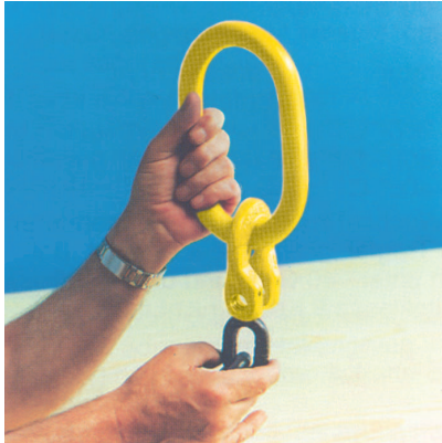
1. Einhängung eines Bergloks über die Flachstelle in einem Ring. Zuführung des Kettenendgliedes in die Berglok-Schäkel-Öffnung
