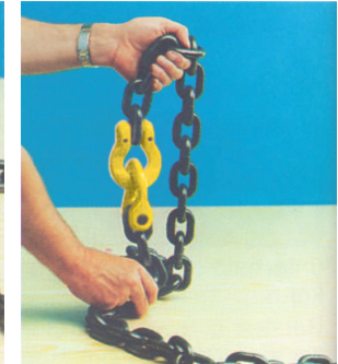
11. Demonstration der verbiegungsfreien Beweglichkeit einer Kettenverbindung durch zwei Bergloks
