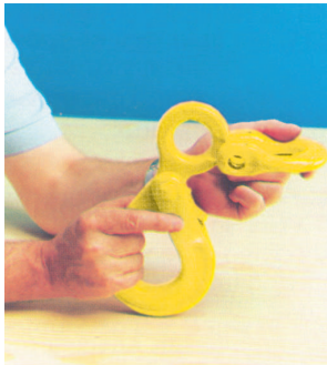
4. Verwechslungsfreie Verbindung eines Ösenhakens mit einem Berglok gleicher Tragfähigkeit
