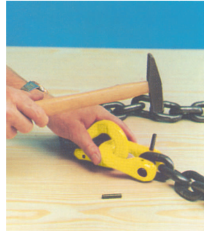
9. + 10. Verbindung mit Bolzen und Sicherungsstift
