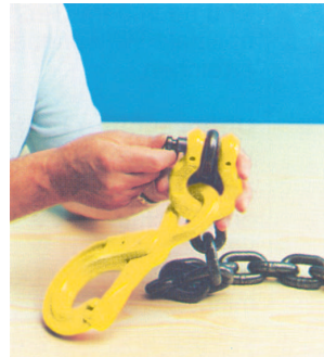
5. Verbindung des Bergloks mit der entsprechenden zugehörigen Kette
